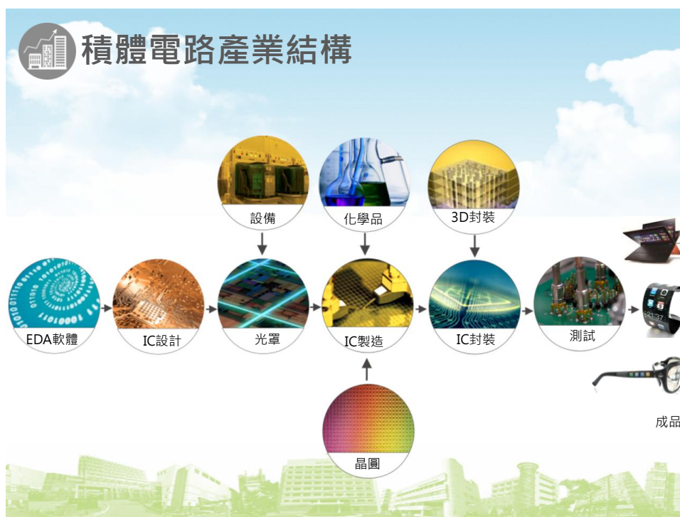
圖 2.積體電路產業結構（資料來源：竹科管理局內部資料）
